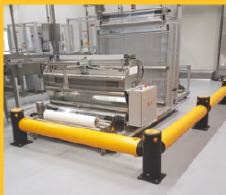
iFlex Enkele Rail beschermt machines in verpakkingsbedrijven.
