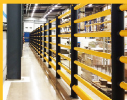
Voetgangershek+ 6 Rails biedt beveiliging tegen het omvallen van goederen in een distributie magazijn.
