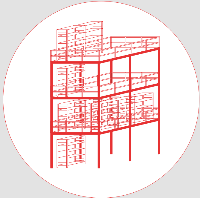
Stalen platform met 4 etages
