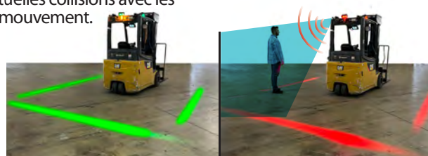
Piéton non détecté.
