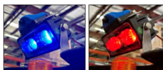
Passe de BLEU fixe à ROUGE clignotant lorsqu'un piéton est détecté.
